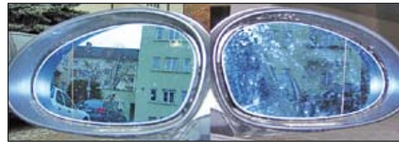
Ein mit Nanopartikeln beschichteter Außenspiegel (links) im Vergleich zu herkömmlichen Spiegeln. (M. Vormoor/Technische Chemie der Leibniz Universität Hannover)
