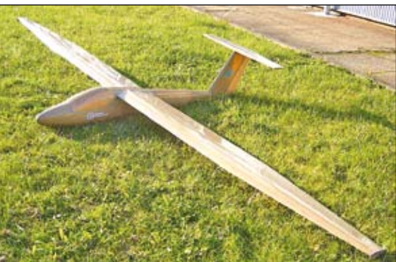
NfK-Flugzeug im Maßstab 1:3 und mit einer Spannweite von 5 m (Reimer Modelltechnik)
